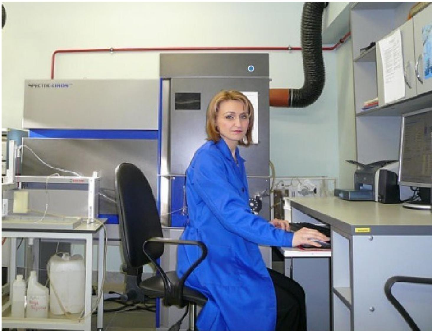
Оптический эмиссионный спектрометр с индуктивно связанной плазмой «SPECTRO CIROS»
