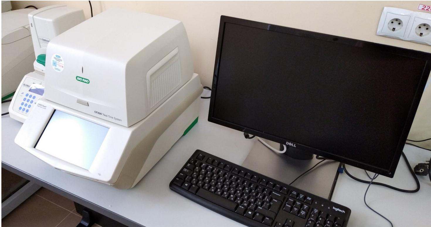
Предназначен для проведения ПЦР в реальном времени и анализа кривой плавления ДНК с высоким разрешением
