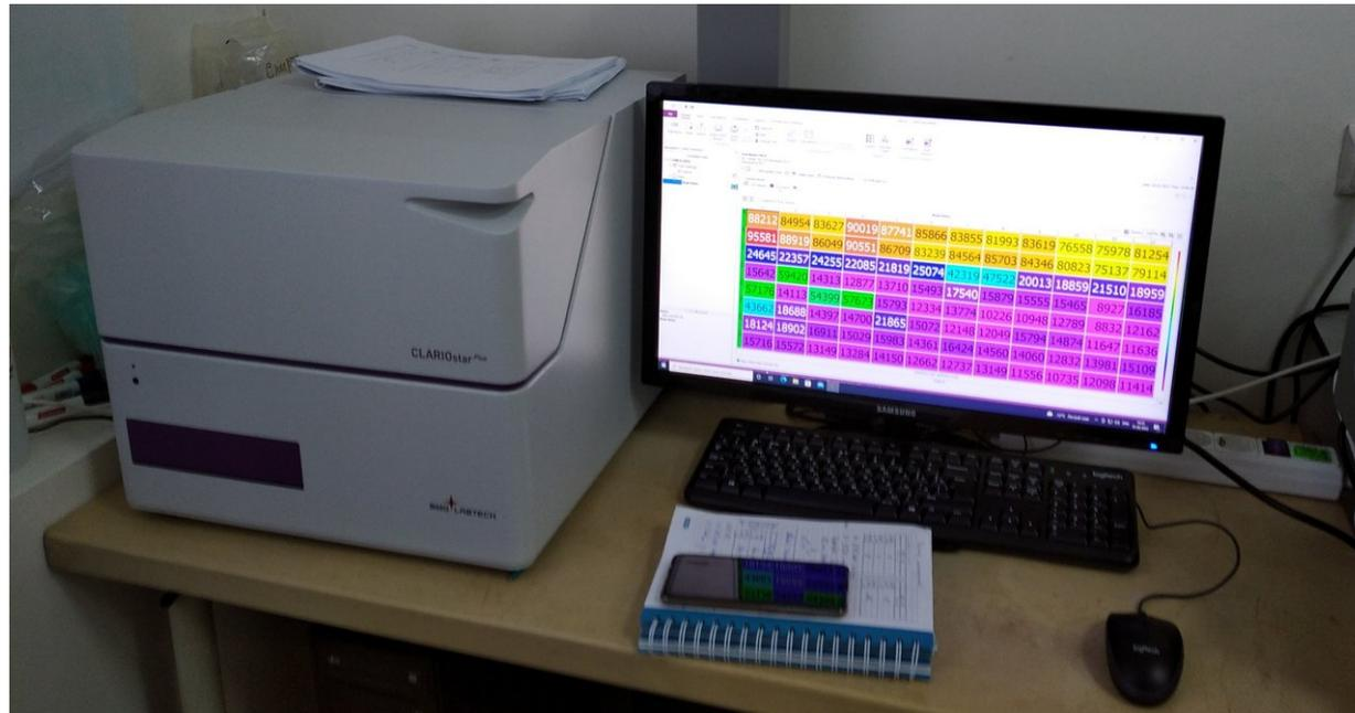
Предназначен для измерения поглощения света, флуоресценции и люминисценции в жидких образцах в многолуночных планшетах. Позволяет осуществлять спектральные измерения, измерения в конечной точке и в динамике.
