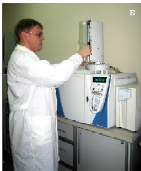
За работой на ВЭЖХ хроматографе «Varian Pro Star» в лаборатории биохимии и биотехнологии (А) и хромато-масс-спектрометре «Trace DSQ» в экоаналитической лаборатории (Б).
