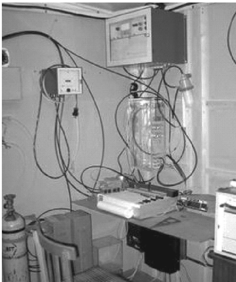
Рис. 10. Проточная измерительная система с газоанализатором Infracit-4.
